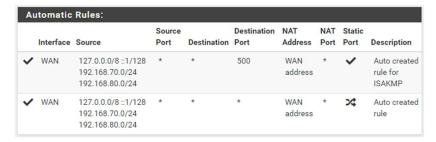
1. Première règle : Le port 500 est utilisé par l'échange de clés Internet (IKE) qui se produit lors de l'établissement de tunnels VPN sécurisés (phase 1 - isakmp). Selon cette règle, quand le numéro du port de la destination est 500, ne pas changer le numéro du port de source après le nattage et garder le même numéro.
